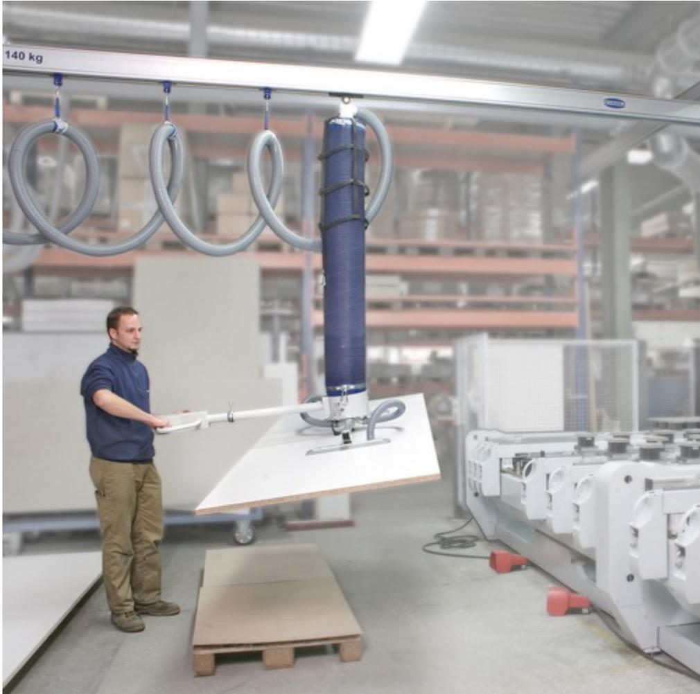
Vakuum-Schlauchheber JumboErgo zur ergonomischen Beladung einer CNC-Holzbearbeitungsmaschine
