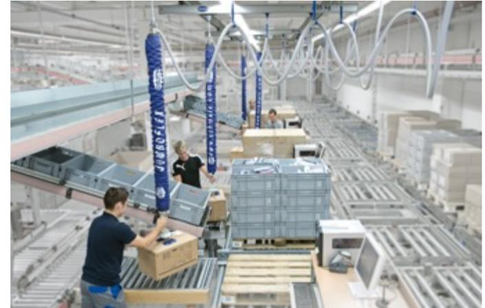
Vakuum-Schlauchheber JumboFlex zur Kommissionierung von Paketen
