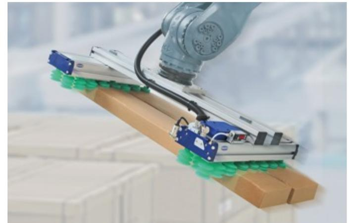
Vakuum-Flächengreifsystem FXP zur flexiblen Handhabung unterschiedlichster Werkstücke
